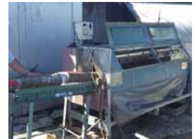
放射性物質の防除施設（ほだ木洗浄機械等）の整備
