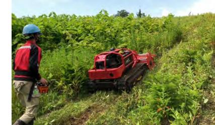
遠隔操作式下刈り作業機械
