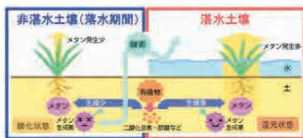
図 メタンが水田で発生するしくみ
