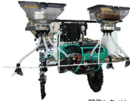
開発したペレット散布機付き除草機 （後方から撮影）
