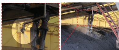
横行型スクリー式攪拌機による鶏ふん堆肥への焼酎蒸留廃液の散布
