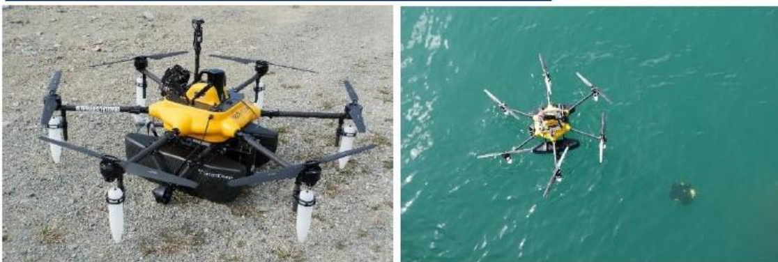
図 16 本機体（左） 親機から分離した子機が潜行する様子（右）
