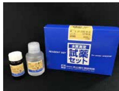
水質測定用試薬セット No.44 COD (株) 共立理化学研究所製 型式：LR-COD-B-2
