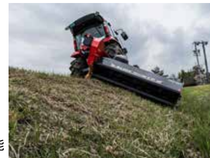
リモコン操作で刈取り角度を調整可能 1.5t以上及び2.35t未満の小型トラクタに装着可能
