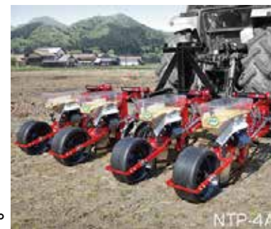
不耕起対応高速汎用播種機（4条仕様） (アグリテクノサーチ株式会社より)
