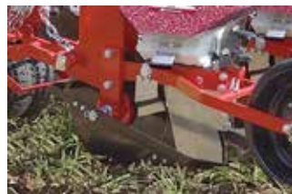
不耕起対応溝切り機構
