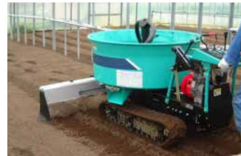
肥料混合散布機 (ブレンドソーワ)
