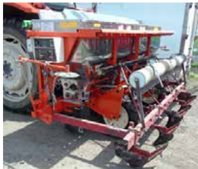
施肥マップ対応型作条施肥機 (サークル機工株式会社製)
