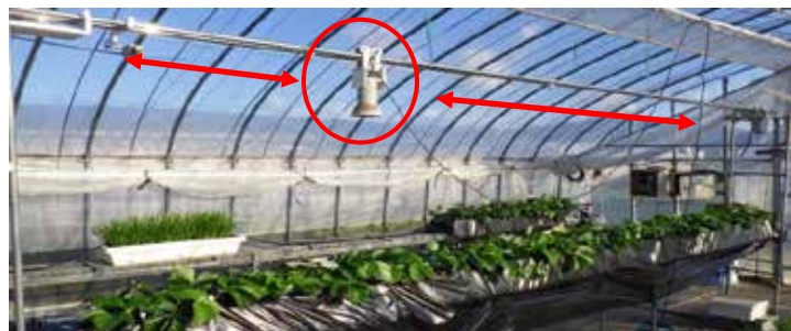
写真 栽培ベッド上を往復移動する超音波照射装置 (広範囲の株に超音波を照射することが可能)
