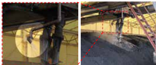
横行型スクリー式攪拌機による鶏ふん堆肥への焼酎蒸留廃液の散布
