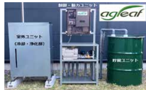
ハウス栽培用CO 2 貯留・供給装置
