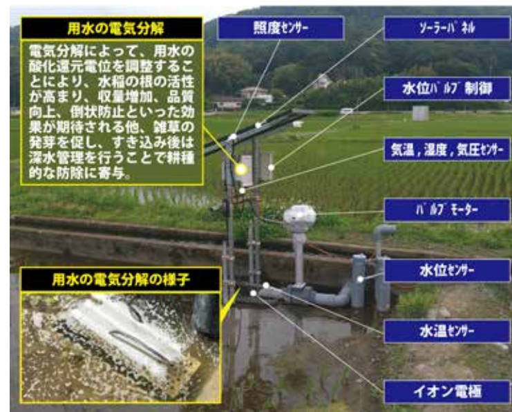
水位自動調整バルブ付き電気分解装置
