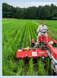
図5 アイガモロボ処理後の機械除草処理
