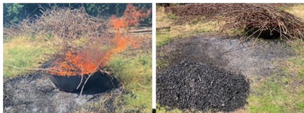
図1 無煙炭化器で炭づくり(左上) 図2 できた炭(右上)
