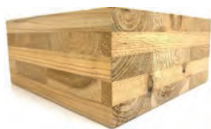
CLT (ひき板を繊維方向に直交積層)
