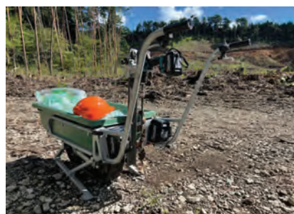
【開発】電動クローラ型1輪車 (35°の急傾斜地でも60kgの荷物を楽に運搬)
