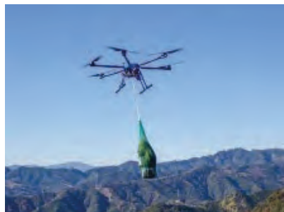
【普及】苗木運搬ドローン (苗木運搬の人工数を約5割省力化)
