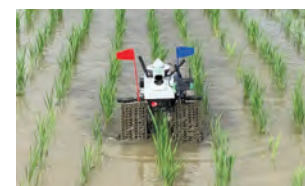
▲栽培管理用AIロボット（水田用） （（国研）農研機構農業機械研究部門開発）
