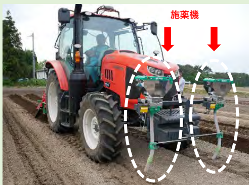
トレンチャーのフロント部分に 施薬機を取り付けた事例
