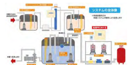
排水リサイクルシステム
