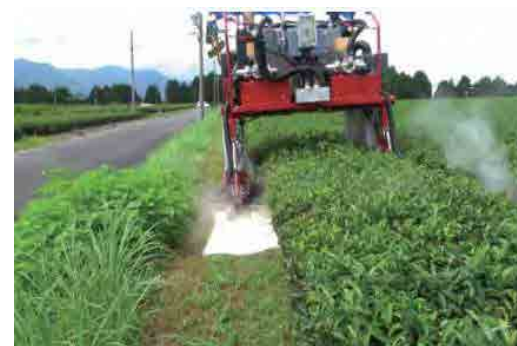
蒸気を畝間に吹き付け
