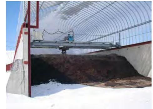
スクリュー式発酵攪拌機
