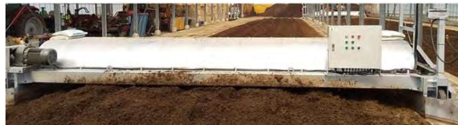
基礎なしロータリー式攪拌機
