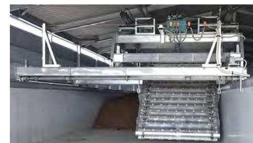
スクープ式攪拌発酵機
