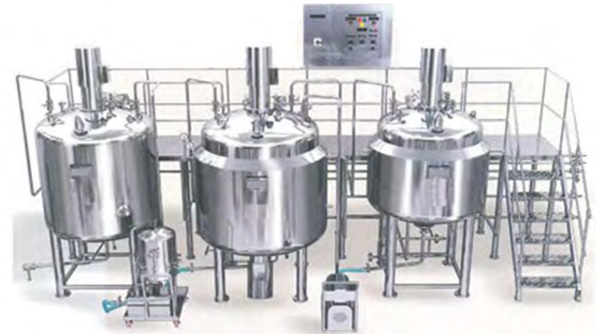
液肥製造プラント
