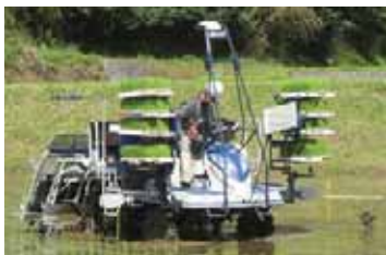
化学肥料の施肥量を減少させる土壌センサ付可変施肥田植機
