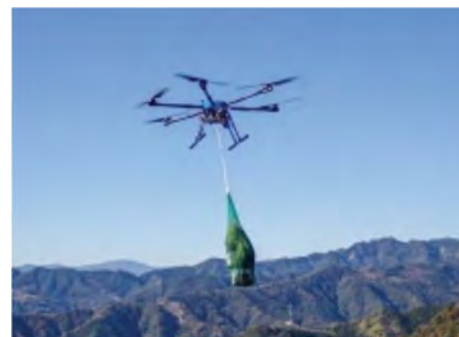
苗木運搬ドローン （苗木運搬の人工数を約5割省力化）
