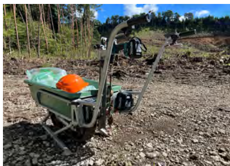
電動クローラ型1輪車 （35°の急傾斜地でも60kgの荷物を楽に運搬）
