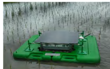
アイガモのように水田を動き回る抑草ロボット
