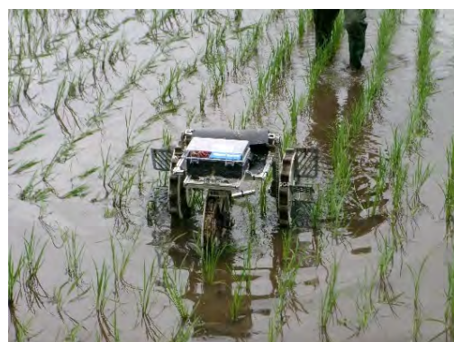
開発中の除草用小型ロボット
