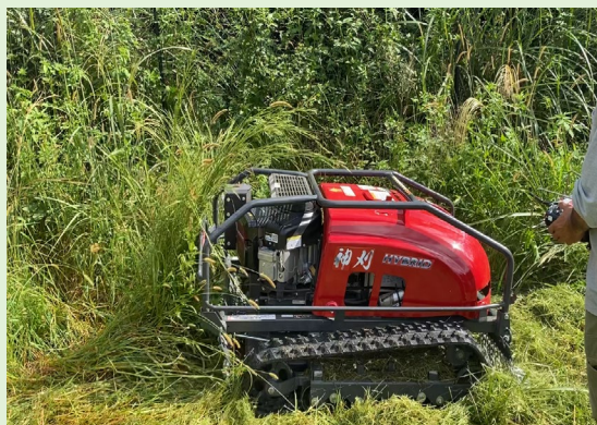
ハイブリッドラジコン草刈機による除草の省力化に係る検証
