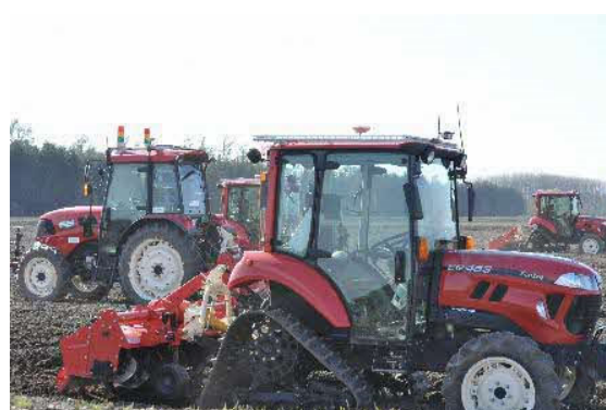
高精度位置測位情報を活用した 協調型ロボットトラクターによる 無人走行の実証風景
