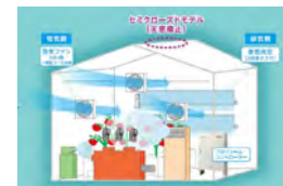
半閉鎖型換気システム
