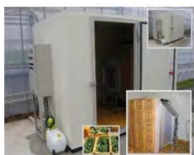
蒸熱処理装置
