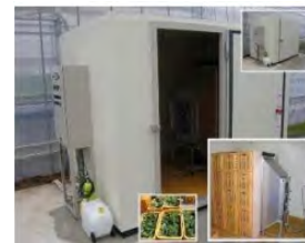
蒸熱処理装置
