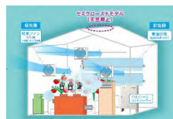
半閉鎖型換気システム
