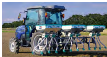
直進アシストトラクタと高精度ソワー
