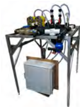
自動灌水・施肥制御装置
