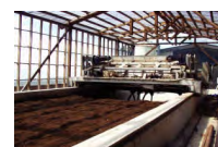
良質な堆肥を供給する 自動攪拌装置
