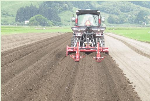
●自動操舵トラクターの活用により、自動で正確な作業を実現。溝切・施肥の作業を2列同時に行うことで作業時間を67%短縮。
