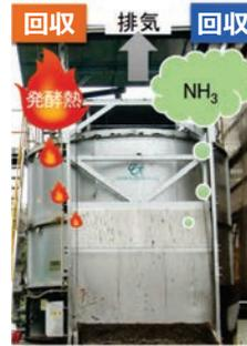
中小家畜で普及している密閉縦型堆肥化装置においても、装置内で発生するアンモニアと発酵熱を回収することが可能。
