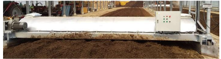
基礎なしロータリー式攪拌機
