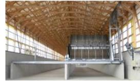
トラバーサー式ロータリー発酵機
