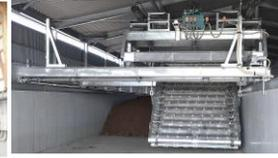
スクープ式攪拌発酵機
