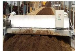
基礎なしロータリー式攪拌機
