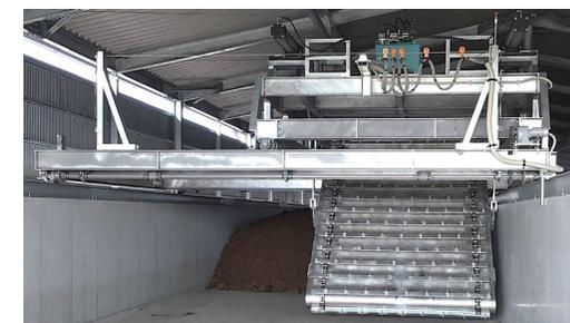
スクープ式攪拌発酵機
