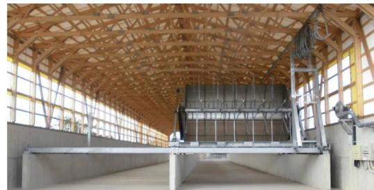
トラバーサー式ロータリー発酵機
