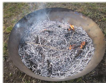
無煙炭化器による 果樹剪定枝の炭化
