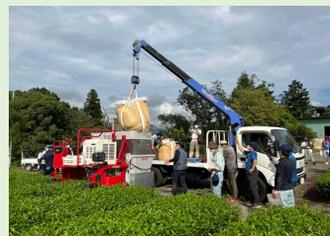
○堆肥散布機への投入方法の検討では、フレコンを利用したユニックでの投入は、人力での投入と比較して60%以上の時間短縮になることが明らかになった。
