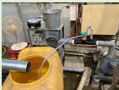
液肥混入器による低濃度エタノールの投入
