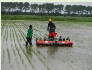
重粘土質土壌に強い乗用水田除草機の実証試験
