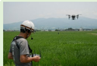
生育診断データに基づいたドローンによる追肥の可変施肥作業
