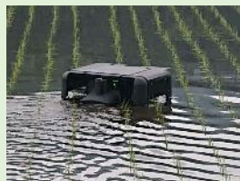
水田用自動抑草ロボットの導入による除草剤の不使用
