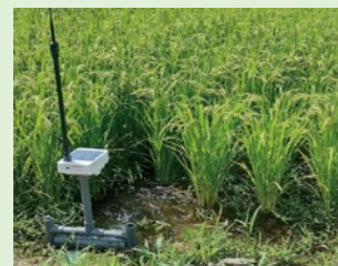
水位センサーと自動水門による省力的な水管理
