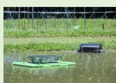
イオン水生成装置と自動抑草ロボットによる雑草抑制の実証試験の様子
