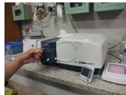
シッパ機能具备了分光光度計 (吸光度測定が可能な分析装置で可)
