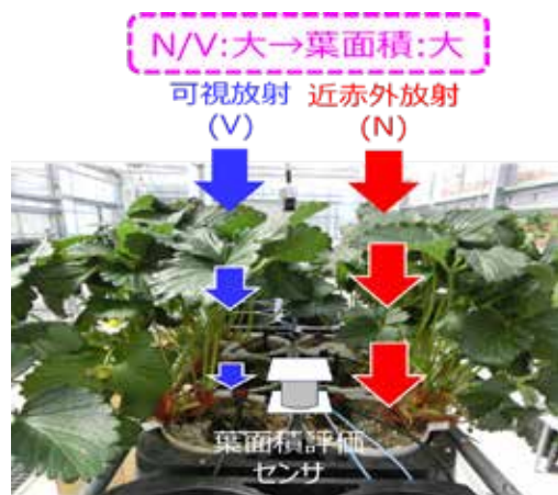
N/Vによる葉面積評価の仕組み
