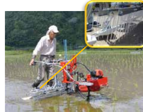
「揺動ブラシ式歩行型除草機」と除草機構「揺動ブラシ」の拡大図
