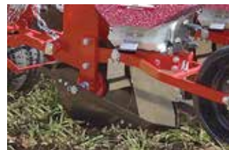
不耕起対応溝切り機構
