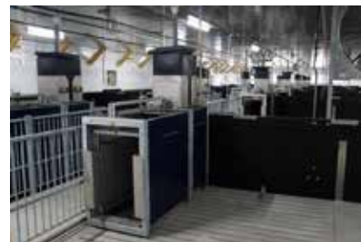
図 豚の体重と飼料摂取量を計測するパフォーマンステスター
