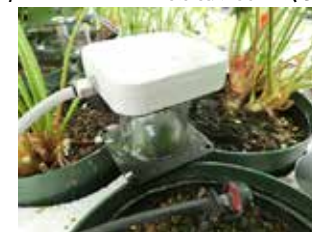
検証中の葉面積評価センサ(実用機)
