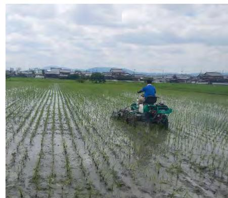
写真2 乗用型水田除草機による除草作業の様子
