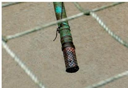
消化液採取用ホースの先に装着したストレーナ（穴の直径8mm）
