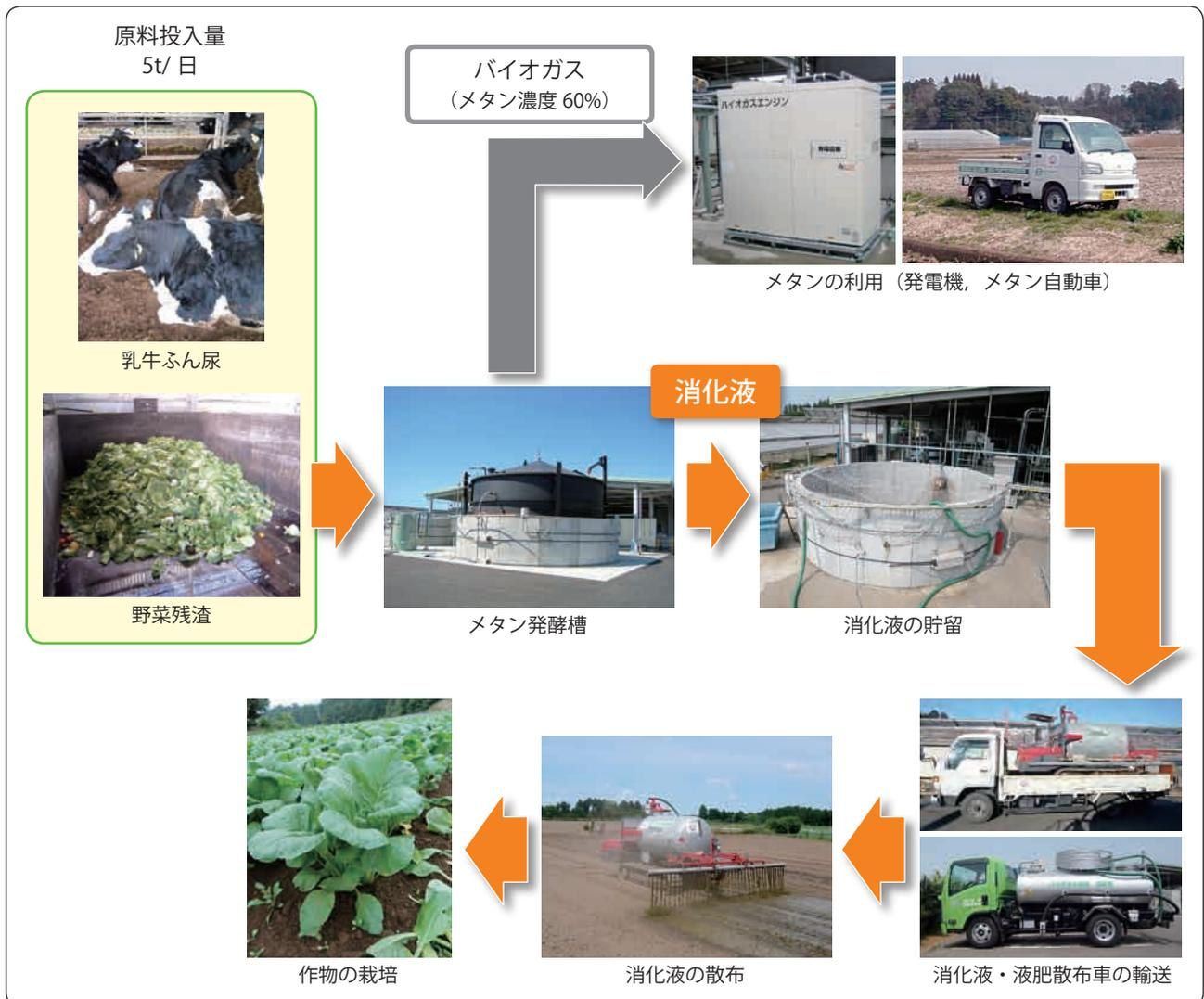
図3 山田バイオマスプラントにおけるメタン発酵消化液の液肥利用プロセス
