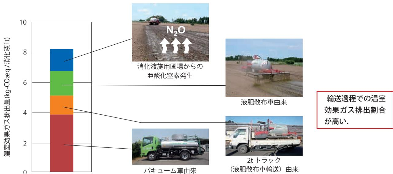
図19 山田バイオマスプラントにおける液肥利用プロセスの温室効果ガス排出量
