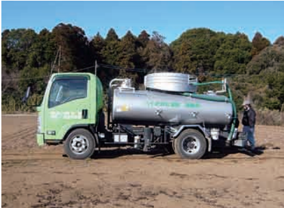
消化液の輸送／バキューム車（タンク容量 3.7m 3 ）
