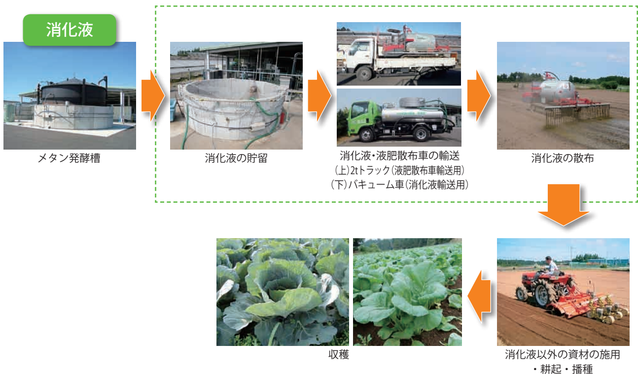
図 21 畑地における消化液の液肥利用プロセス
