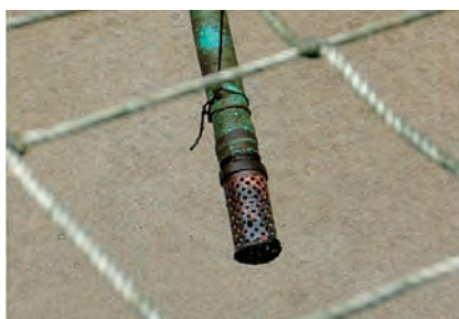
消化液採取用ホースの先に装着したストレーナ（穴の直径8mm）
