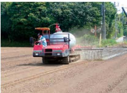
消化液の散布／液肥散布車（タンク容量 1.6m 3 ）
