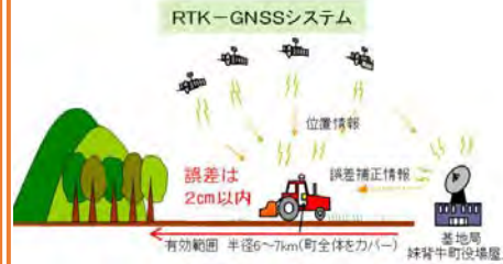
RTK-GNSS基地局の導入
