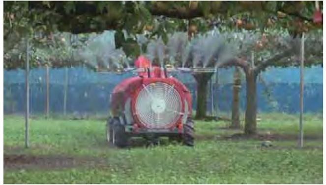
開発中の低飛散型SS（生研センター提供）
