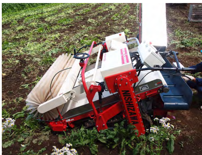
図 2-1 加工用野菜収穫機（農水省加工プロ開発機 MNSH-1300）
