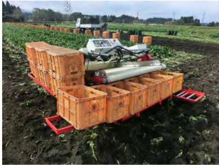
図 2-8 プラスチックコンテナを搭載した加工野菜収穫機
