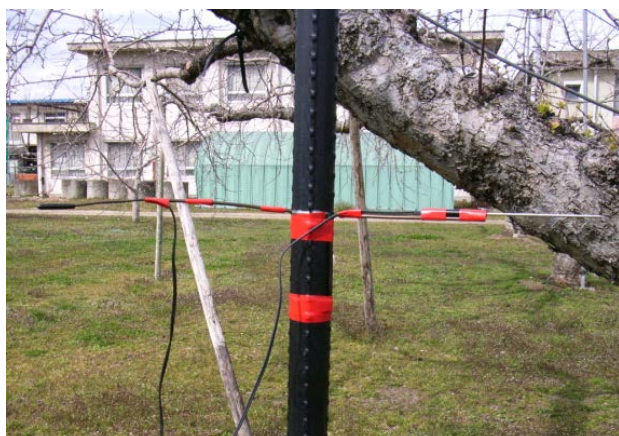
図4 TPE樹脂被服の汎用型センサー
