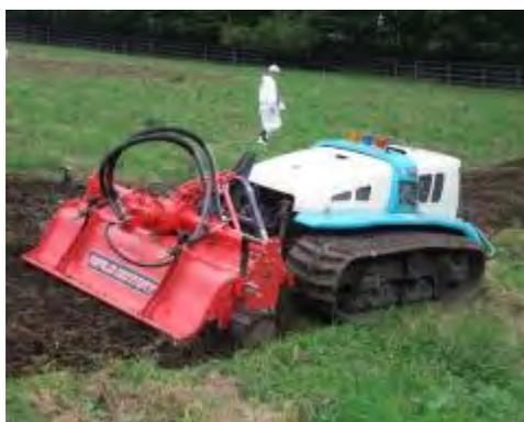
写真13 無線トラクターによるロータリー作業
