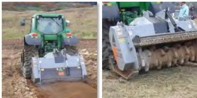
写真14 ストーンクラッシャによる石礫破碎と同時の耕耘
