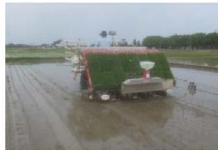
300g播きの密苗を、8条植え田植機に16箱積載で、30a圃場を苗補給なしで移植作業が可能
