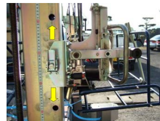
(特願2013-099899) 操縦盤の高さをオペレータの身長に調節できる
