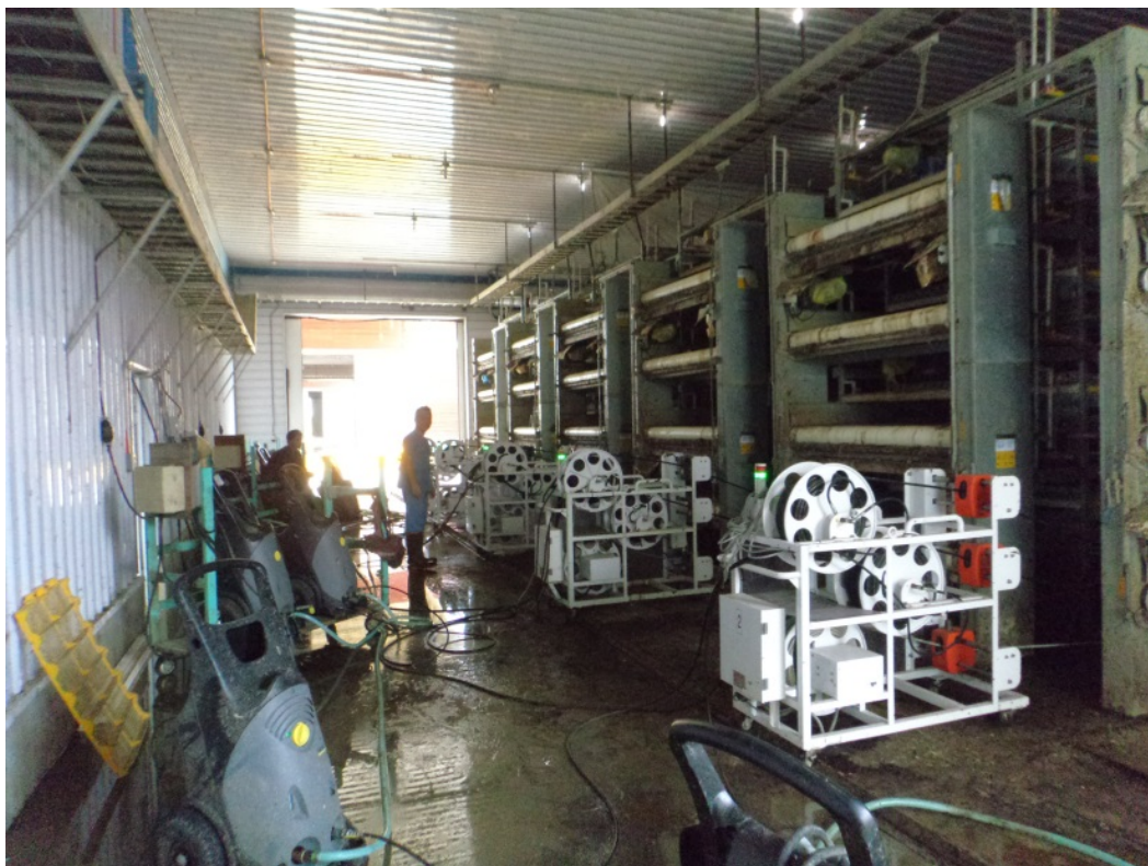
フィリピンB農場での導入例 洗浄時間短縮のため、複数台同時運転。(白い機械がVENUS)
