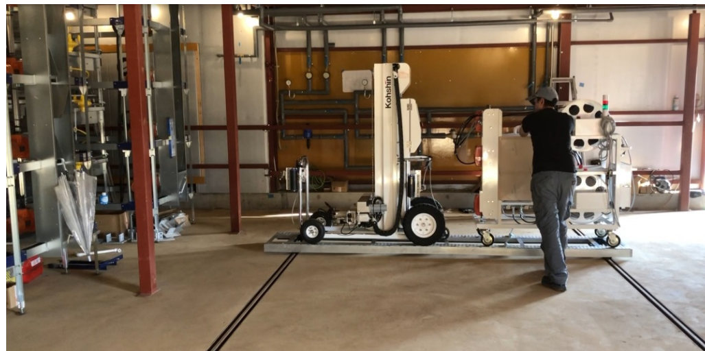
建築段階からVENUSを鶏舎設計に組み込み。 床にレールを埋め込みしてVENUSの通路間移動を容易にした。
