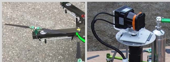
飛行制御はブレードピッチ角で制御
