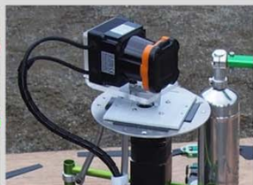
三次元スキャナセンサをモータで回転
