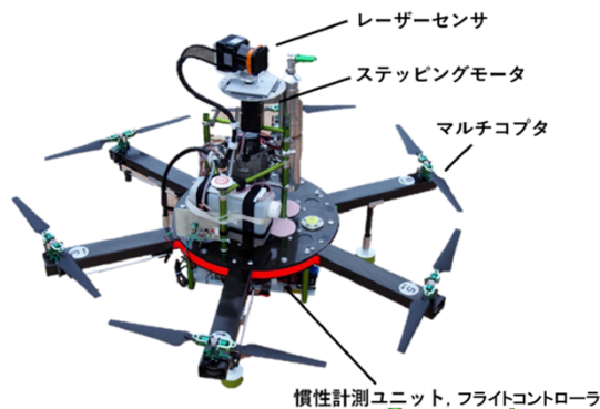
図1: LiDARを搭載したエンジン型ドローン
