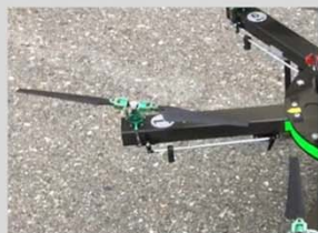
飛行制御はブレードピッチ角で制御
