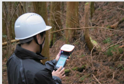
外部 GNSS 受信機を活用した測量
