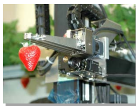
安定したイチゴ識別により、システムを確実に把持できる
