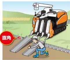
● 10cm以上の段差は高さの4倍以上の長さのあひみ板を設置して直角に渡ります。
