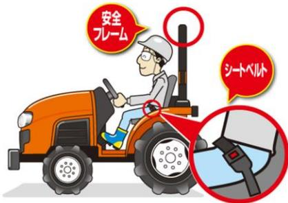
● 安全キャブ・安全フレーム付きのトラクタを使い、シートベルトを必ず装着します。
